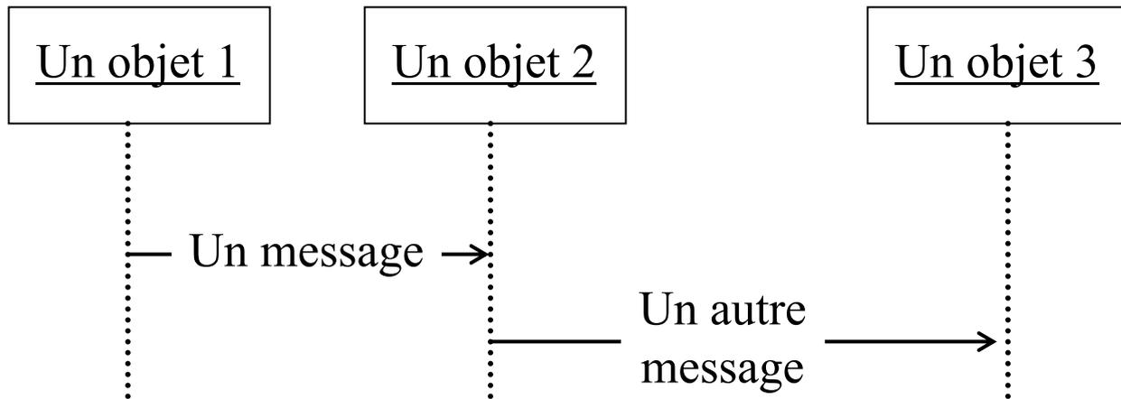
La dimension verticale représente l'écoulement dans le temps (de haut en bas par défaut). L'ordre d'envoi est ainsi donné par la position des messages sur les lignes de vie des objets. Il est possible de graduer la dimension verticale pour exprimer précisément les contraintes temporelles. La dimension horizontale n'a pas de signification particulière.
